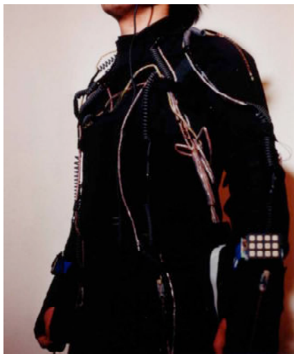
Fig, 4-1 Douze capteurs de flexion sont fixés à chaque articulation
