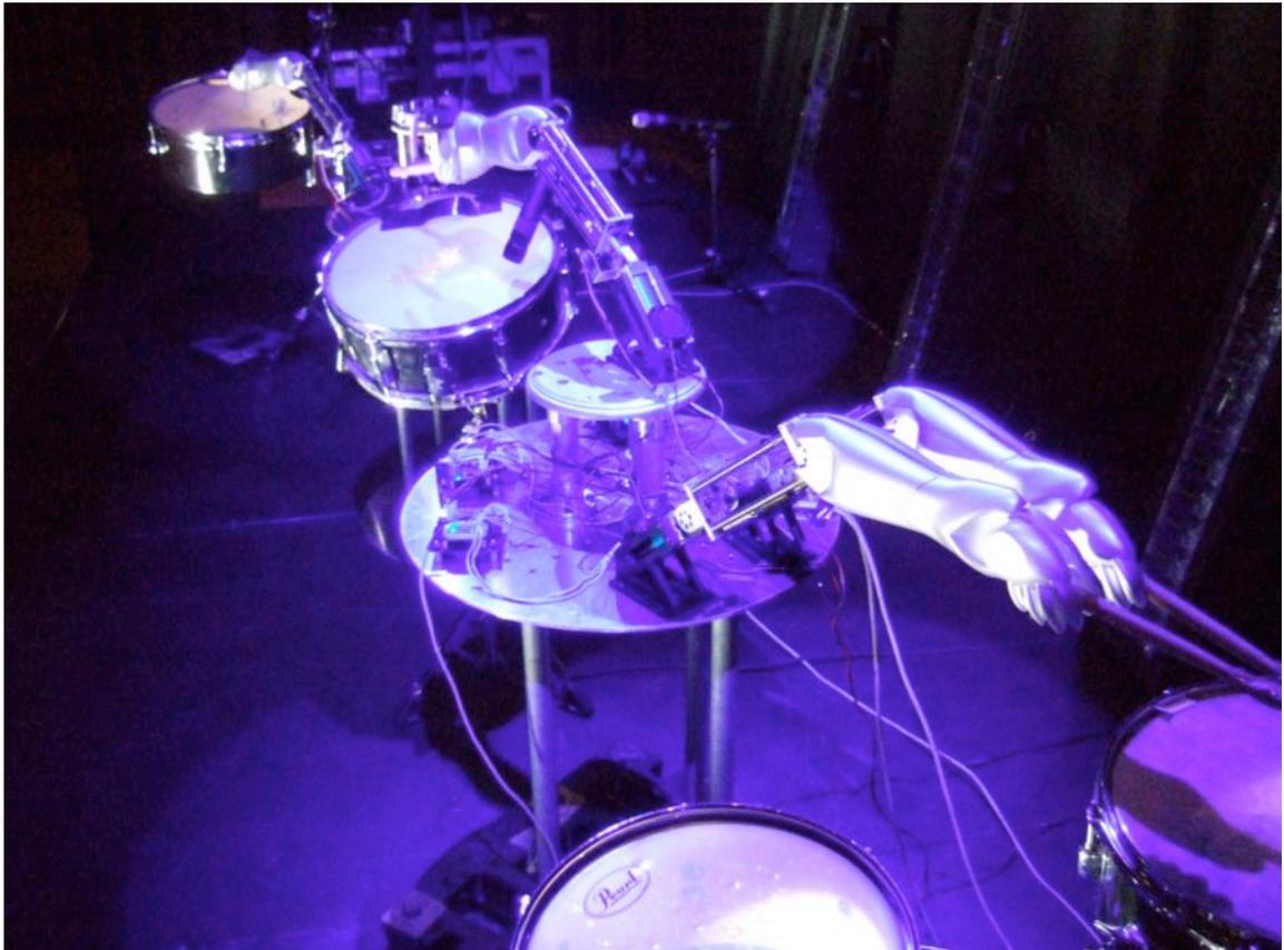
ロボットには人間の筋肉を模倣するため特別なスプリングが取り付けられている。さらに打楽器のマレットがアームの先に持たれる。
