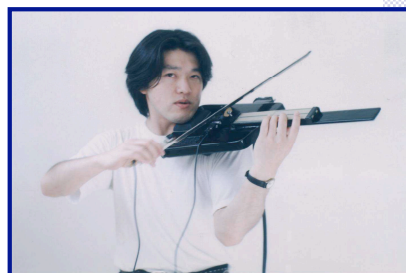
弓はSuperPolm本体上にある鉄製のブリッジと触れる地点によって数値を変化させる
